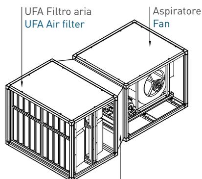
Condotto di raccordo a carico dell'installatore
